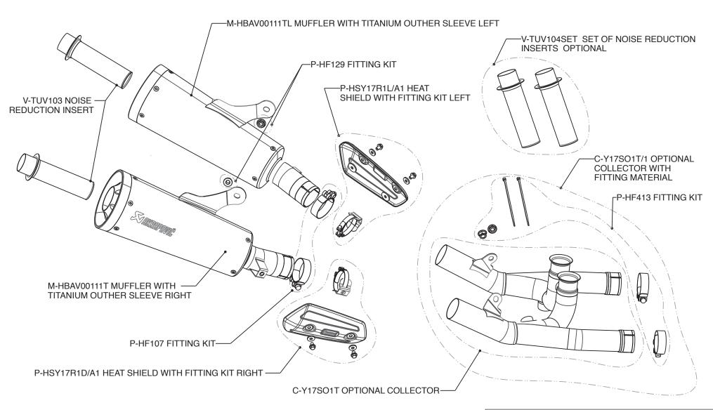
WARNING! IN COMBINATION WITH OPTIONAL COLLECTOR, THE SLIP-ON HOMOLOGATION IS NOT VALID!
